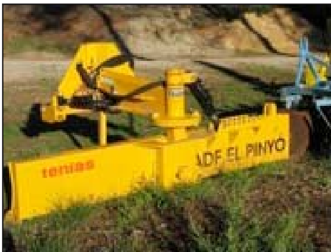
Imatge 29: Pala anivelladora. Font: DGMN.
